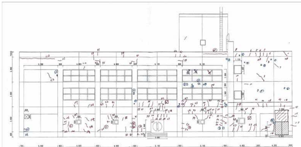
クラック 113か所（概数）、コンクリート爆裂 19か所（概数）
