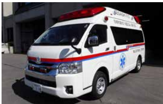
▲町内を走行する新たな高規格救急車 高度救命処置用機材を搭載している他、新型コロナウイルス感染防止策として車内は防護壁で仕切られている
